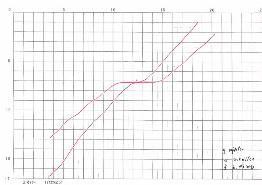
图 10 微波辐照下，高温超导双晶约瑟夫森结的电压-电流变化曲线 (x 轴分度值 2.5mV/cm,y 轴分度值 10 $\mu$ V/cm)
