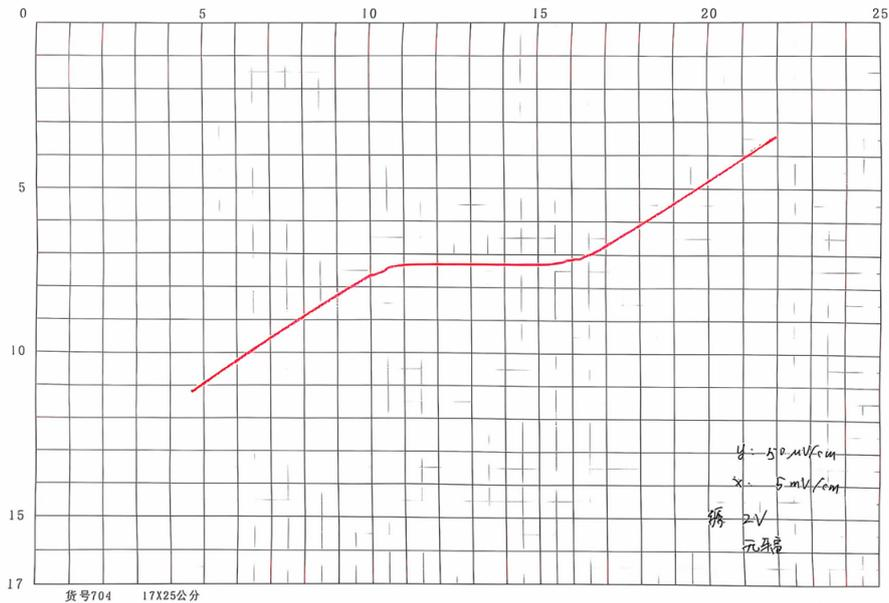
图 8 高温超导双晶约瑟夫森结在无微波辐照下的伏安特性曲线 (x 轴分度值  $5\text{mV/cm}$ , y 轴分度值  $50\mu\text{V/cm}$ )
